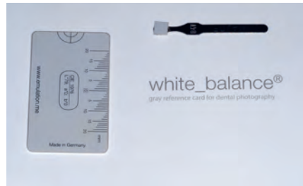
Figura 10. Guía de referencia de escala de grises para la corrección digital de la exposición.
