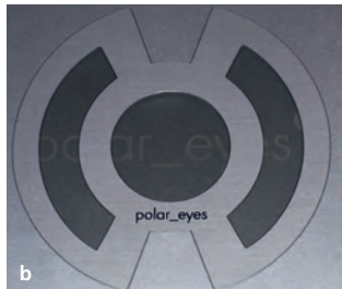
Figuras 9a y b. Filtros de polarización cruzada para mitigar el deslumbramiento y visualizar en detalle las superficies brillantes.
