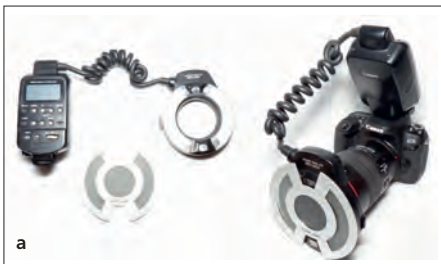
Figuras 9a y b. Filtros de polarización cruzada para mitigar el deslumbramiento y visualizar en detalle las superficies brillantes.
