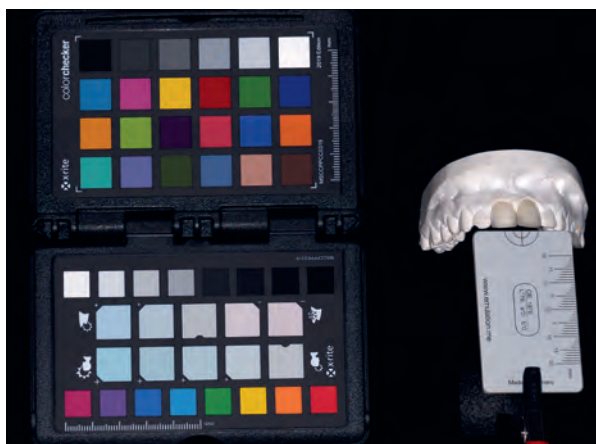
Figura 12. Soporte de la guía de referencia del color para crear diferentes perfiles de cámara.
