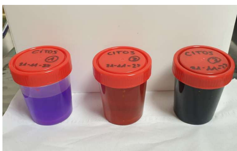
Figura 6.9. Imagen de las tres soluciones que componen la tinción de Diff-Quik: la solución nº 1 es el fijador, la solución nº 2 es el colorante acidófilo (eosina) y la nº 3 el colorante basófilo (azul de metileno).
