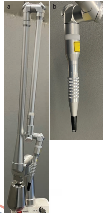
Figura 2.7. a. Sistema de administración de brazo articulado. b. Pieza de mano utilizada normalmente en un sistema de administración de brazo articulado.
