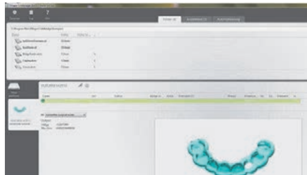
Figura 5. Importación de los datos de construcción en el programa CAMbridge y creación de un building job .
