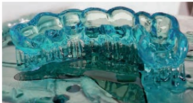
Figura 9. Después de la impresión, ha de retirarse el objeto de la plataforma de construcción y limpiarse. Después de separar los soportes, se realiza la posexposición sobre el modelo protésico.
