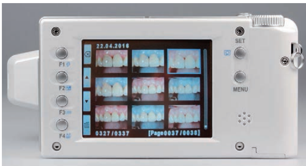
Figura 14. La capacidad de archivo y gestión de las imágenes que permite EyeSpecial C-II, son esencialmente equiparables a las de un ordenador. La memoria de trabajo abarca unas 600 fotografías.
