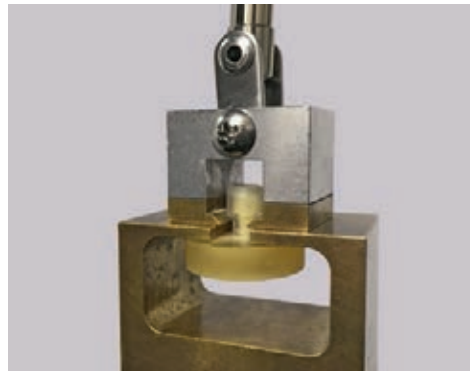
Figura 10. Montaje del ensayo para comprobar la resistencia a la tracción de la muestra de estudio.
